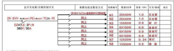
总功率为6.34KW, 总开关锁定电流为30A, 电压为380V, 阻燃双护套线.
